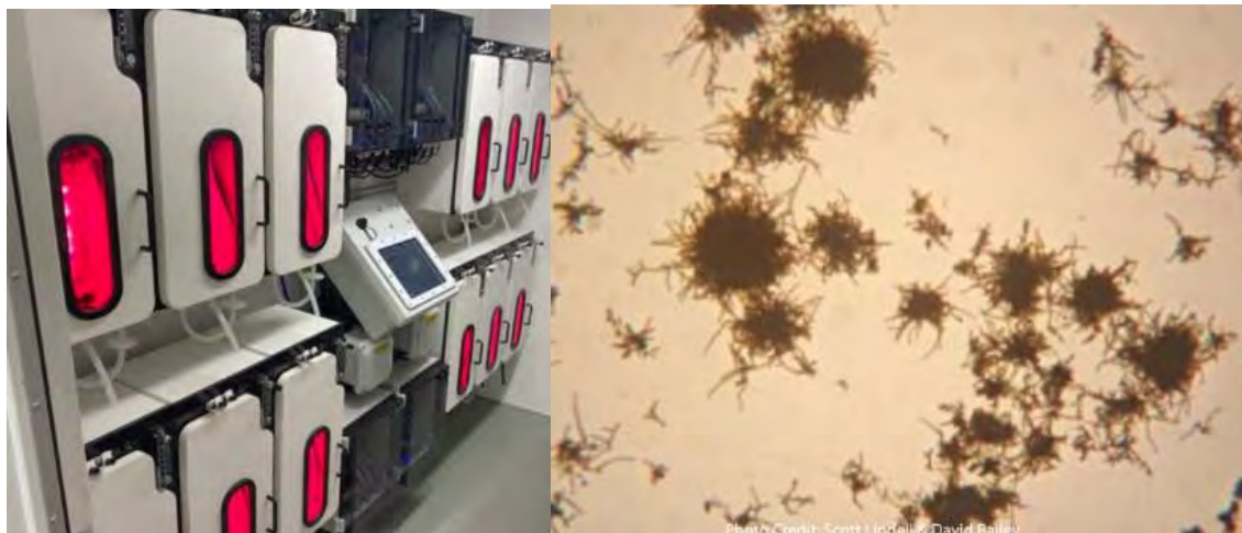
Slika 26. Bioreaktor za multiplikaciju makro algi-gametofiti u stadiju razvoja (Plankton industrial inc.)
